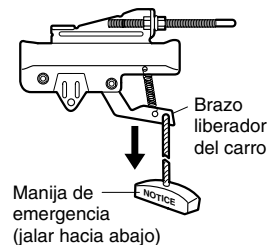
POSICIÓN DE DESENGANCHE MANUAL
